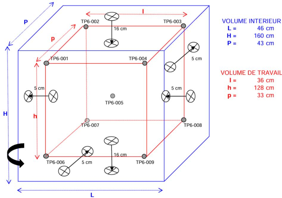
La cartographie ou caractérisation d'une enceinte consiste à vérifier sa stabilité, son homogénéité en plaçant plusieurs capteurs de température dans l'enceinte.
